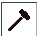
Kunststof hamer voor het bevestigen van eindkappen
